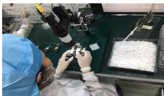
ภาพ 5 การตรวจสอบชิ้นงานด้วยกล้อง CCD
